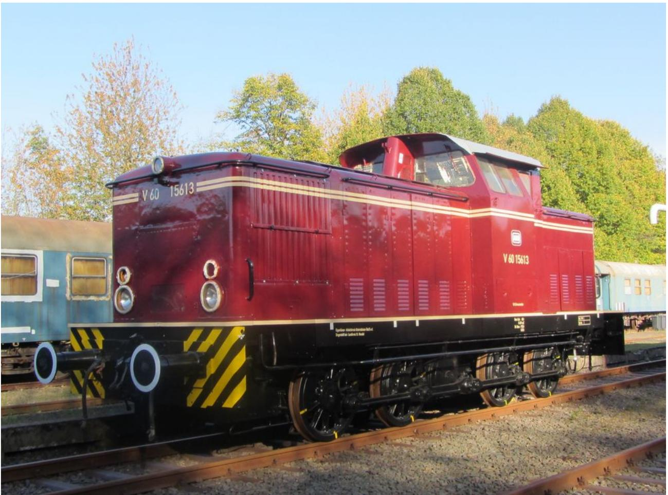
Nach ihrer seit 1955 laufenden Entwicklung bei der DR fertigte der VEB Lokomotivbau-Elektrotechnische Werke Hennigsdorf seit 1964 die vierachsigen dieselhydraulischen Lokomotiven für den Einsatz im mittelschweren Rangierdienst und leichten Streckendienst. Mit 2.256 Loks war V 60 D eine der meistgebauten europäischen Baureihen.
